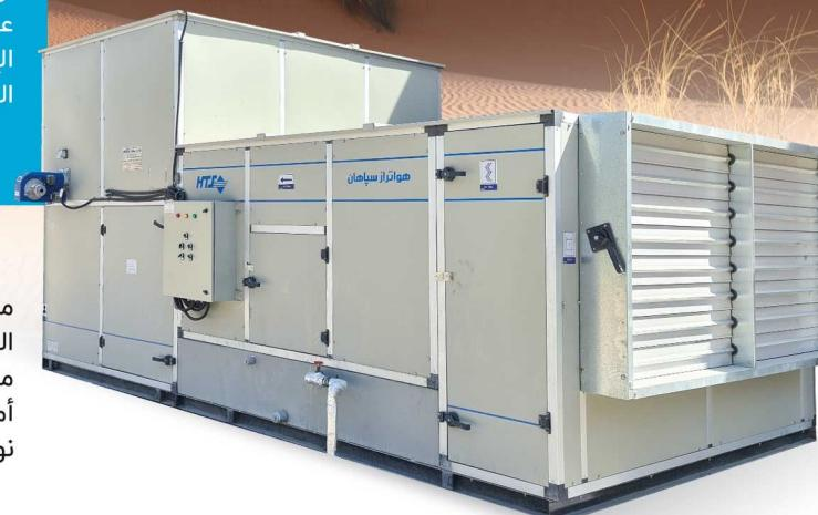
فرن هذا الجهاز مصنوع من الفولاذ مقاوم للصدأ بسمك ٢ مم مع ممرات حرارية فولاذية ثلاثة المراحل. تتم جميع عمليات اللحام بواسطة CO2 ومع معايير اللحام والفحص. يتكون هيكل الجهاز من الألミニوم المؤكسد المقطوع تماماً كمعايير ومتصل ببولي أميد أو ألومنيوم PRP-LAM. مضخة الماء للجهاز من ماركة ABARA نوع جهاز الطرد المركزي الموجود بجانب الجهاز.
